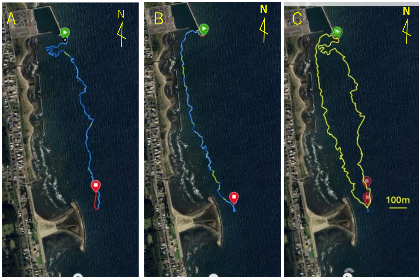
図4 2名のダイバーによるアマモ群落縁辺部の軌跡 (A, B)及び両者による奇跡を合成して得られたアマモ群落の範囲(C).
